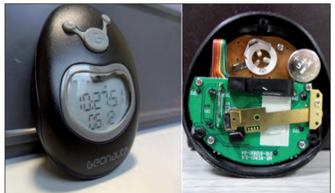
□ □ Figure 1: présentation extérieure et intérieure du podomètre Dista F100
